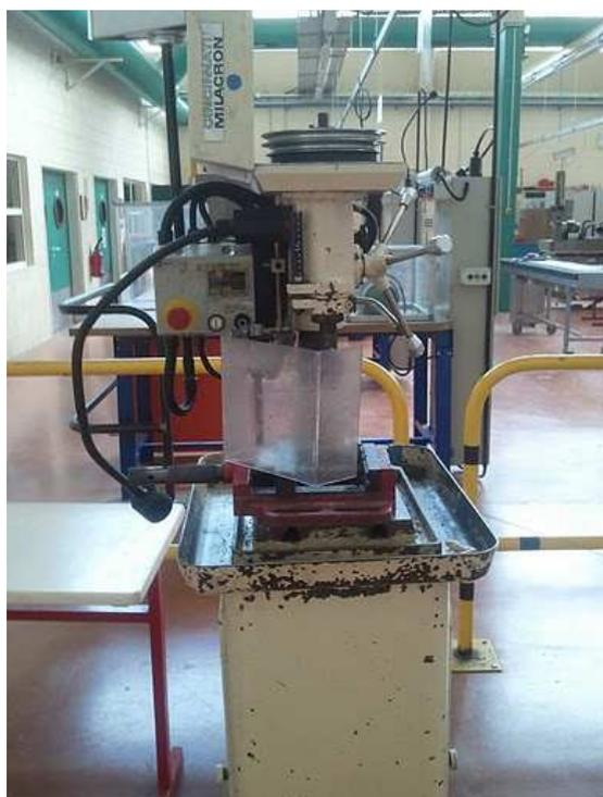
La perceuse à colonne est un outil assez spécialisé qui convient surtout pour le travail des métaux. Elle permet d'obtenir une grande précision dans l'ouverture des trous borgnes ou traversants. On l'utilise aussi pour le taraudage automatique, car elle permet la réalisation de pas de vis parfaitement finis. La perceuse peut également recevoir des fraises et différents outils à tige adaptables dans le mandrin.
